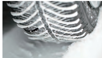
センターエリアのサイブ側面にワッフル状の凹凸を形成。ブロック間が支えあい、高い剛性を生み出します。
